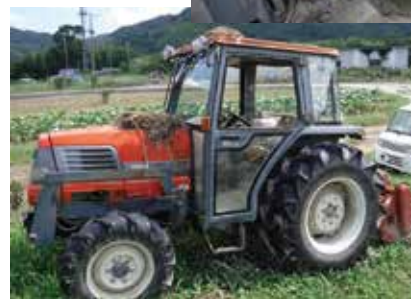
水没し、内部にも水と土砂が流入したトラクタ
